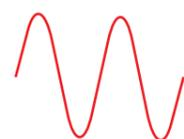
Les modèles Pure Sinus délivrent une tension parfaitement stable, de même qualité que le réseau électrique. Ils alimentent ainsi tous les appareils, même les plus sensibles (néon, écran plasma, ordinateur fixe, etc).
